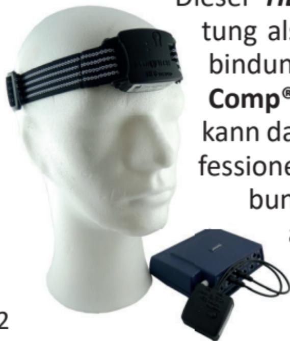
Dieser **HEG neuro Connector** (in dieser Anleitung als **Connector** bezeichnet) stellt die Verbindung zwischen **HEG neuro** und einem **ProComp**<sup>®</sup> von Thought Technology her. Damit kann das **HEG neuro** auch als Sensor in die professionelle Arbeit mit **BioGraph**<sup>®</sup> **Infiniti** eingebunden werden, um die Vorteile des HEG als sehr leicht einsetzbare Methode zu nutzen und mit anderen Parametern zu kombinieren.
